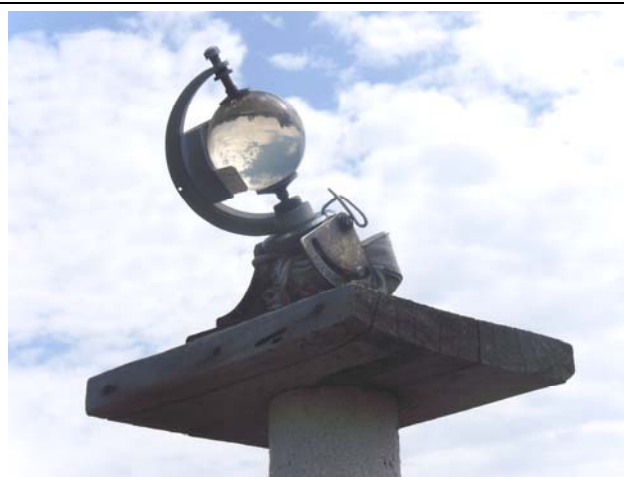
Гелиограф (для определения продолжительности солнечного сияния)
