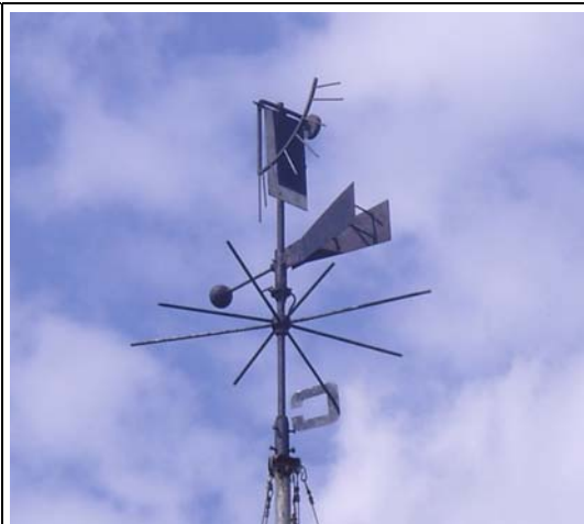
Флюгер (определяет направление и скорость ветра)
