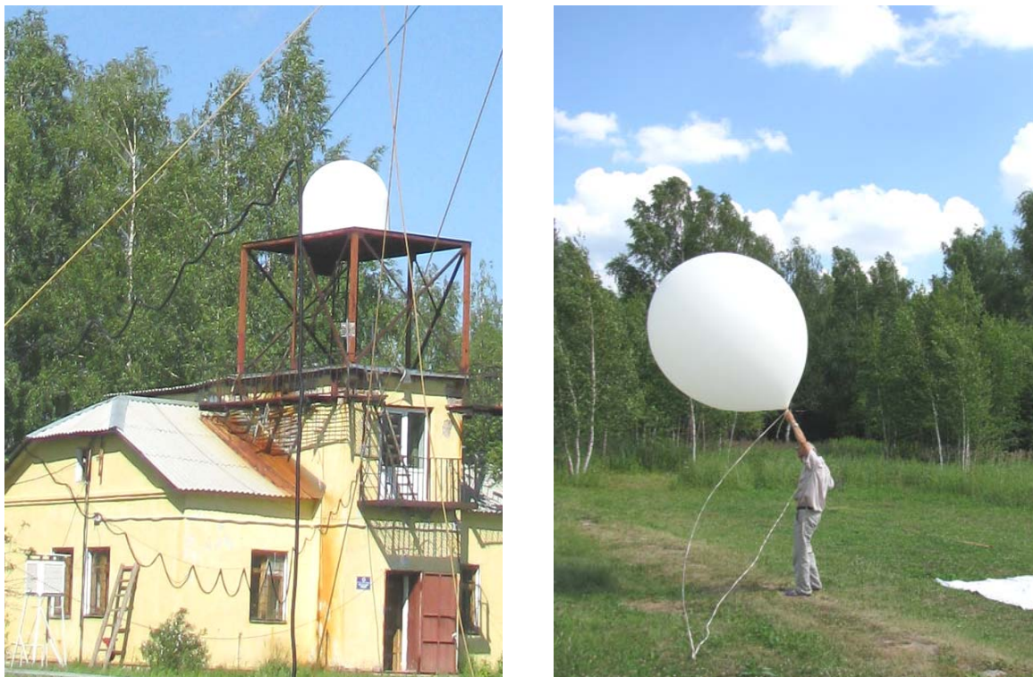
Рис. 3.10. Аэрологические измерения на метеостанции 27730: вид на здание метеостанции с аэрологическим радиолокатором (слева), запуск радиозонда (справа) (фото С. А. Тобратова)
