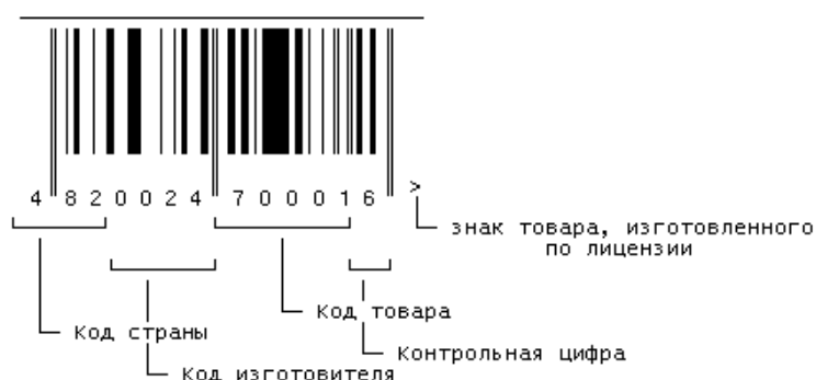
Рисунок 1 Образец штрихового кода в системе EAN-13
