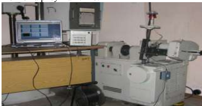
Рис. 7. Общий вид триботехнического комплекса для исследования приработки
