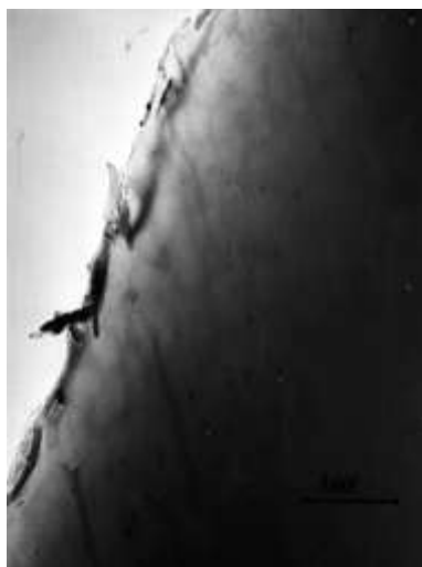
Рис. 8. Микроструктура приповерхностной области пластины кремния после имплантации ионов мышьяка, E = 100 \text{ кэВ} , D = 1000 \text{ мкКл/см}^2 ( 6 \cdot 10^{15} \text{ ион/см}^2 )
