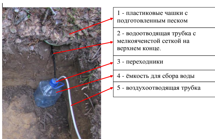
Рис. 5. Установка для сбора лизиметрических вод
